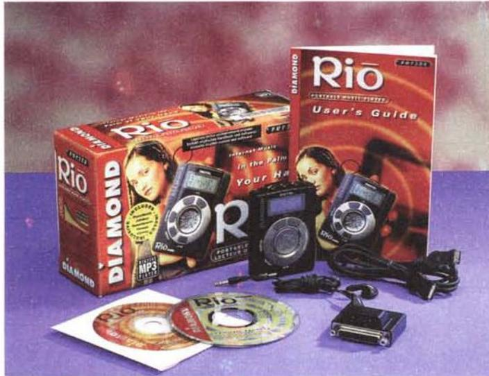
mo anche la presa per la connessione con il computer, che utilizza un cavo che assomiglia molto a quelli utilizzati nei telefonini. Tale cavo si connette da un lato al Rio, dall'altro ad una piccola interfaccia che va connessa alla porta stampante del computer. Quest'ultima ha inoltre anche un connettore di uscita per consentire di utilizzare anche la stampante senza scollegare o collegare fili.
